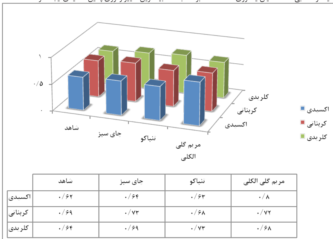
تصویر ۵. داده‌های شدت نور بازتابی از رنگ سطح قرائت‌شده با دستگاه چگالی‌سنج نوری در آثار تاریخی - مطالعاتی، غوطه‌ور شده در بازدارنده‌های جدید و بدون بازدارنده (شاهد)، (نگارندگان)
